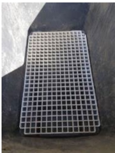
Figure 20 : Grille en plastique facilitant l'égouttage des bacs en rehaussant le prélèvement du robinet de vidange (Source : Cedre)
