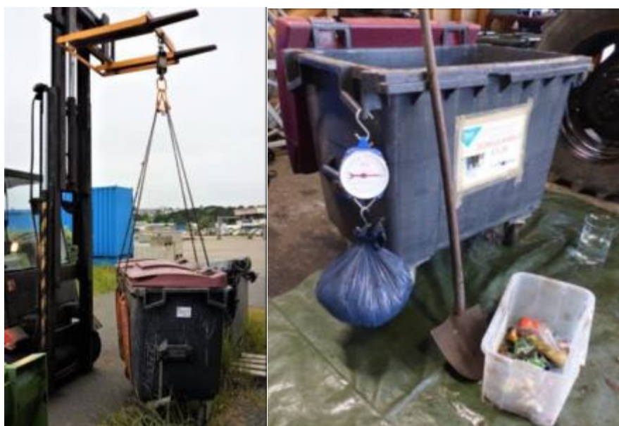
Figure 21 : Pesons utilisés afin de déterminer la masse des prélèvements : peson électronique (à gauche) ; peson dynamométrique (à droite) (Source : Cedre)
