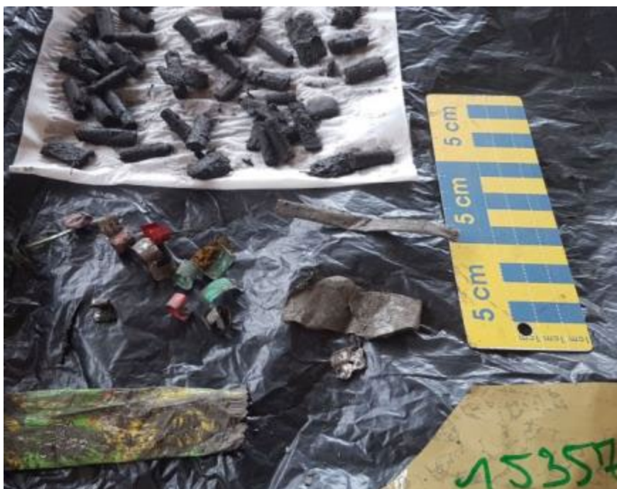
Figure 52 : Prélèvements des seaux siphoides provenant des avaloirs n°15357 (Source : Cedre). Sur le haut de la photo il y a des mégots, à gauche des confettis, à droite un emballage de filtre et des fragments et en bas un emballage de gâteau.
